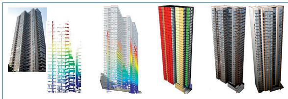
图3 融合点云和图像建筑物三维重建
